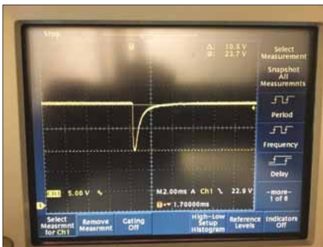
Рис. 4. Падение напряжения аккумуляторной батареи при броске тока через аккумулятор (см. рис. 3)
